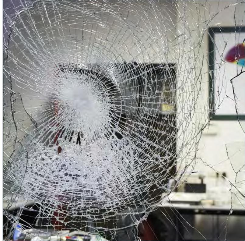
PROFILON® P3A ist eine mehrlagige durchwurfhemmende Sicherheitsfolie und eine Weiterentwicklung der schon als Top Produkt bekannten PROFILON® AXA1 (P2A). Sie ist die weltweit einzige Sicherheitsfolie, die auf der Glasinnenseite foliert wird und nach der durchwurfhemmenden Klasse P3A gemäss DIN EN 356 zertifiziert wurde. Zusätzlich verfügt diese Folie über sprengwirkungshemmende Eigenschaften und ist schwer entflammbar.
